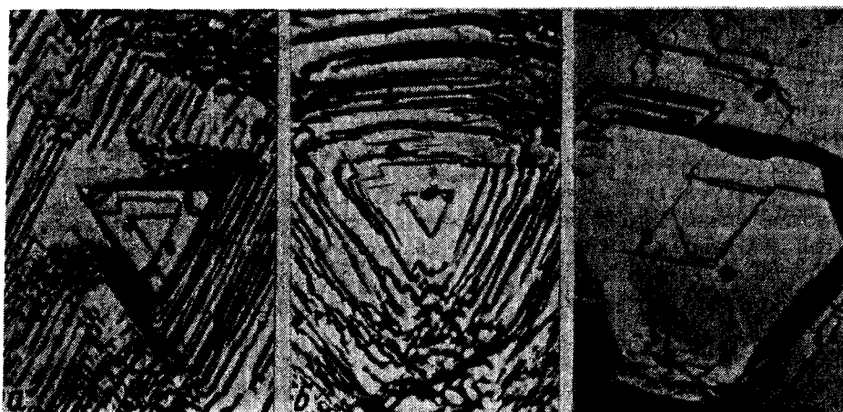
Рис. 2. Развитие ступеней растворения от единичного подповерхностного дефекта в системе (111) \text{Ni} / 1\text{M HNO}_3 при плотности анодного тока i_a = 50 \text{ A} \cdot \text{м}^{-2} , 298 К; увел. в 960 \times ; с: а — 20, б — 40, в — 60
